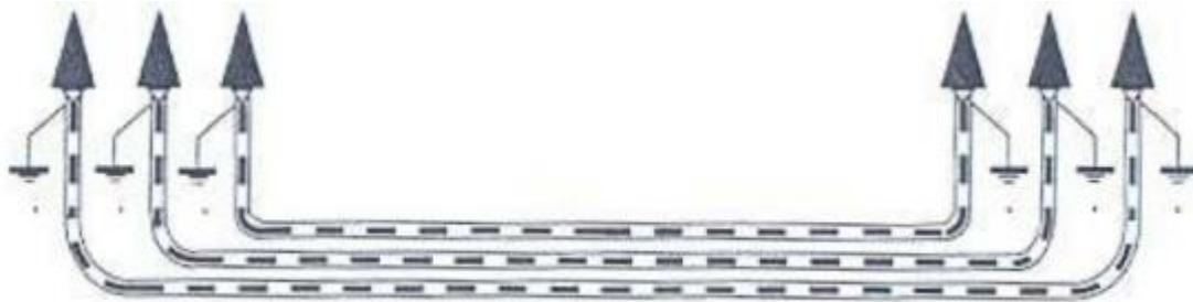
Figura 29: Puesta a tierra de cubiertas metálicas.
